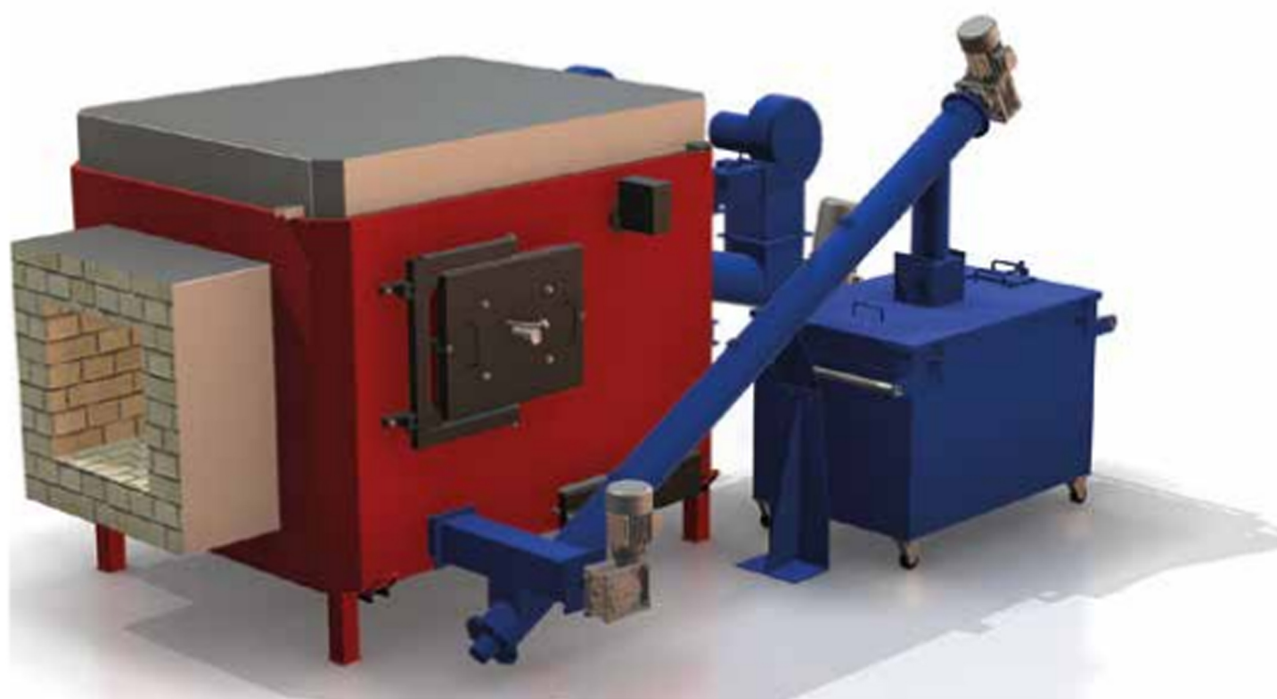
▶ Przedpaleniska typu AZSD mogą spalać odpady o wysokiej wilgotności.
